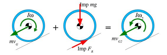
Impulso lineal en el eje paralelo al plano inclinado:
