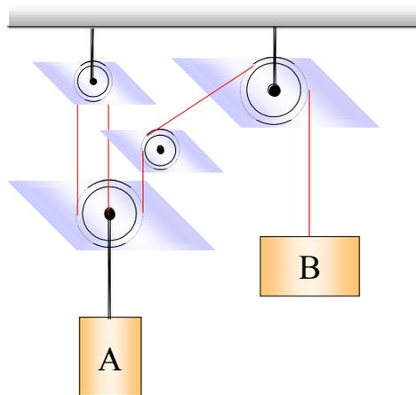
A continuación se establecen variables escalares que determinen la posición de cada elemento móvil, en este caso como el movimiento de cada bloque es en una dimensión se necesita sólo una variable por cada bloque, por lo tanto sólo se requieren dos variables en total. La forma de hacer esto es simplemente establecer una cota entre un punto fijo y un punto del objeto en movimiento o que se mueva a la misma velocidad de éste.
