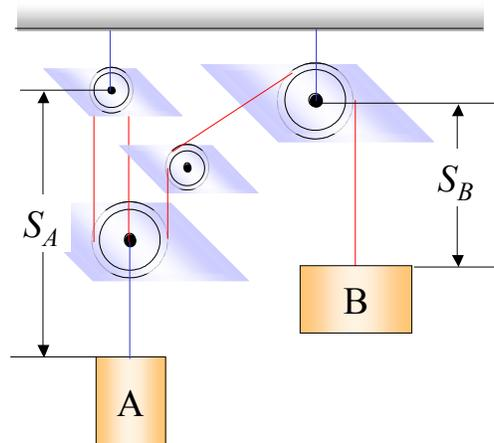
El siguiente paso es expresar la longitud de la cuerda que une a los bloques en función de las cotas y de una serie de constantes que para propósitos ilustrativos se muestran en la figura inferior.
