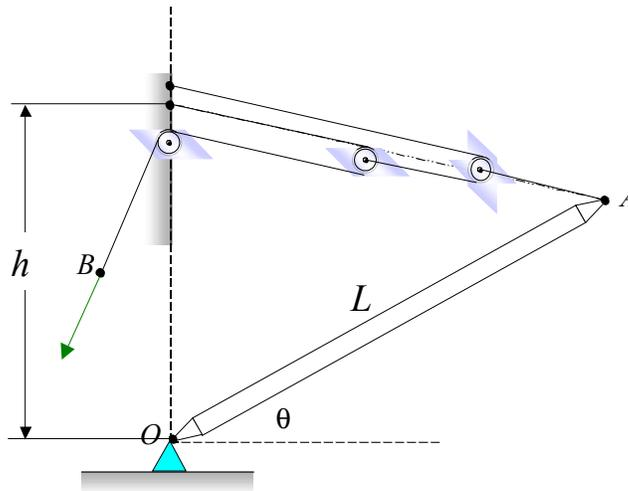
Supóngase que se desea encontrar la variación del ángulo  $\theta$  que define la orientación del mástil de longitud  $L$  en función de la velocidad con la que se hala el cable en B.
