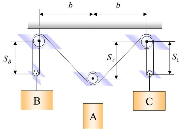
Es preciso hacer notar que para expresar de una manera simple la longitud de la cuerda, los diámetros de las poleas que conectan las partes de los cables que cambian de orientación deben ser lo suficientemente pequeñas (por lo menos diez veces menor) en comparación con la longitud del mismo como para despreciar su diámetro, lo anterior permite expresar la longitud del cable inclinado en función de la distancia entre centros de las poleas:
